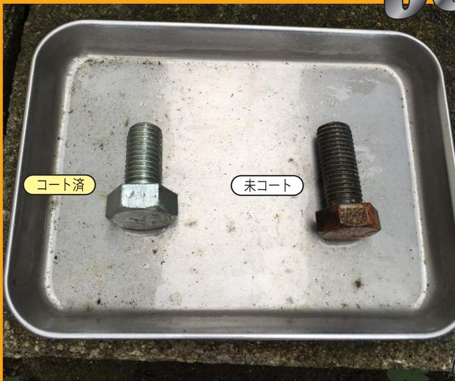
風雨にさらされ続ける屋外のボルトを、サビから強力にガード
